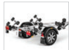
Dotazione multi rullo per totale protezione dello scafo
