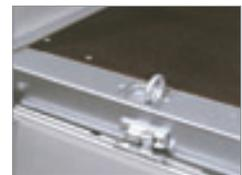
Robusti anelli per fissaggio carico alloggiati nella cornice interna del pianale
