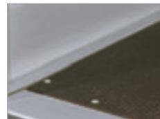
Profilo in acciaio di protezione al piano di carico
